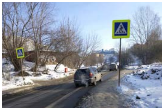
Рисунок 3. Пешеходный переход на маршруте 1: не обеспечен «треугольник видимости», разметка отсутствует
